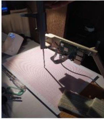
Εικόνα 2.17 Κατασκευή στήριξης κάμερας
