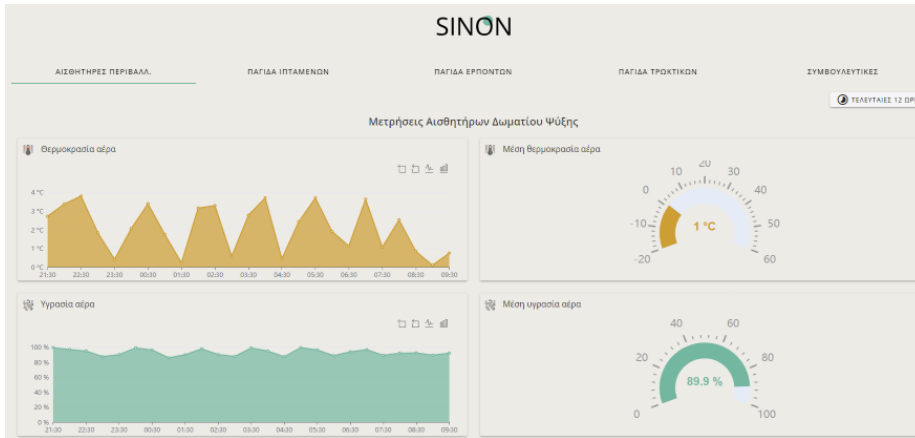
Εικόνα 2.25 Μετρήσεις θερμοκρασίας αέρα/μέσης θερμοκρασίας αέρα/υγρασίας αέρα/μέσης υγρασίας αέρα δωματίων ψύξης
