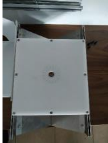
Εικόνα 2.4 Σημείο υποδοχής κάμερας κάτω από τη μεταλλική οροφή της παγίδας
