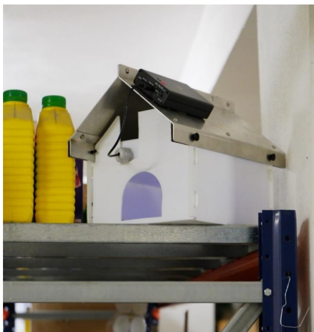
Εικόνα 2.2 Εγκατεστημένη παγίδα ιπτάμενων εντόμων στην αποθήκη του καταστήματος της Μασούτης ΑΕ
