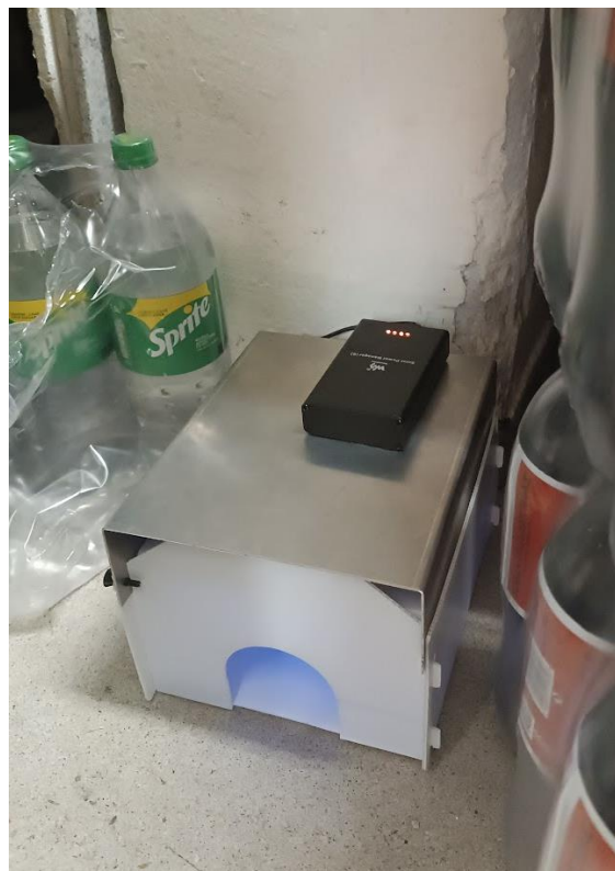
Εικόνα 2.7 Εγκατεστημένη παγίδα βαδιστικών εντόμων στην αποθήκη του καταστήματος της Μασούτης ΑΕ
