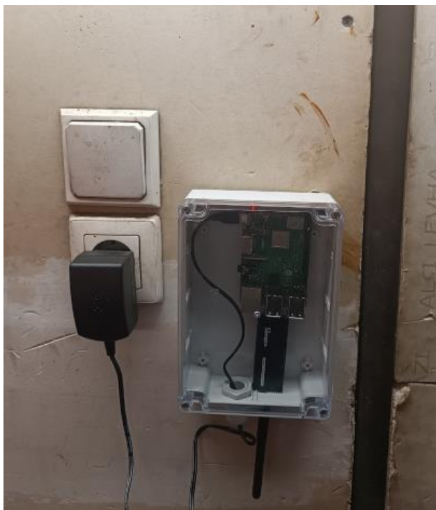
Εικόνα 2.13 Κόμβος διαδικτυακής πύλης τοποθετημένος στους αποθηκευτικούς χώρους του καταστήματος της Μασούτης ΑΕ
