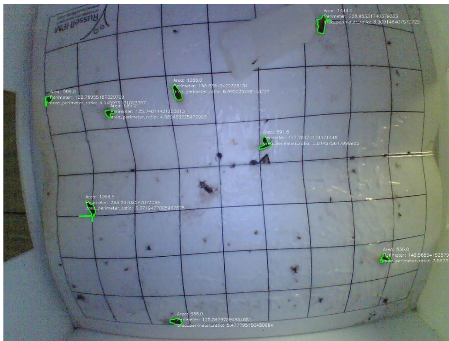
Εικόνα 3.3 Διαδικασία επεξεργασίας εικόνας από παγίδα ιπτάμενων εντόμων. Μέσω της χρήσης των απαραίτητων λογισμικών και της βιβλιοθήκης OpenCV πραγματοποιήθηκε εντοπισμός και καταμέτρηση των συλληφθέντων ιπτάμενων εντόμων
