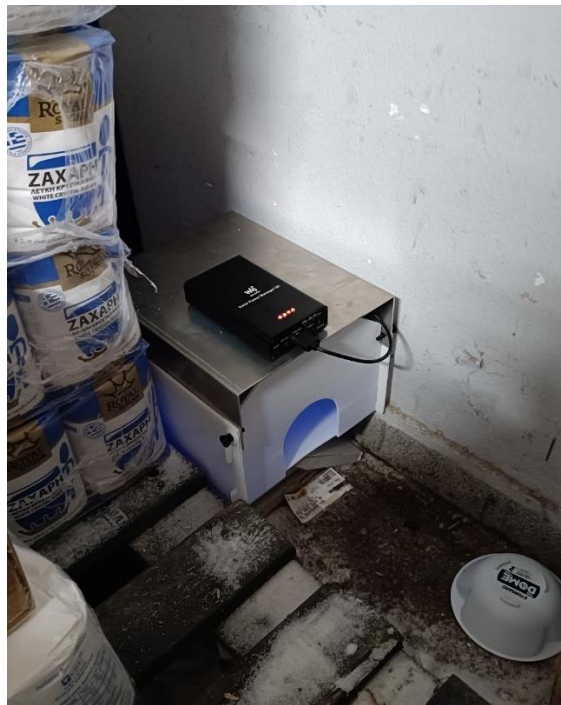
Εικόνα 2.6 Εγκατεστημένη παγίδα βαδιστικών εντόμων στην αποθήκη του καταστήματος της Μασούτης ΑΕ στη Θεσσαλονίκη
