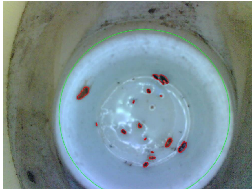
Εικόνα 3.2 Επεξεργασία εικόνας παγίδας βαδιστικών εντόμων. Μέσω της χρήσης των απαραίτητων λογισμικών και της βιβλιοθήκης OpenCV πραγματοποιήθηκε εντοπισμός και καταμέτρηση των συλληφθέντων εντόμων. Είναι σημαντικό η κάμερα να είναι κεντραρισμένη με τη επιφάνεια σύλληψης των εντόμων έτσι ώστε να μη δυσκολεύεται ο αλγόριθμος να ανταποκριθεί στον εντοπισμό και στην καταμέτρησή τους
